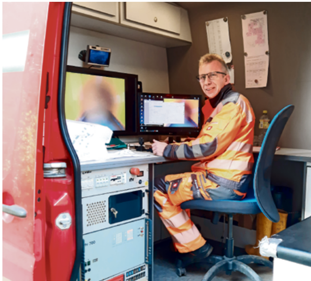
▲ Der Mitarbeiter kann die Aufnahmen aus dem Kanal sofort auf dem Bildschirm im Fahrzeug sehen. Fotos: ZV
